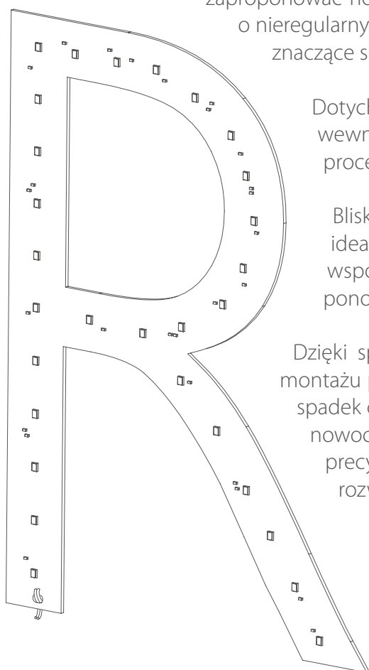
Przykład zastosowania: Prefabrykowany moduł LED w formie litery, gotowy do natychmiastowego użycia. Kształt można dowolnie modyfikować.
